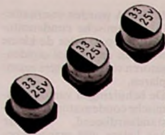
Afb. 18 Natte elektrolytische condensatoren in SMA-vorm.
